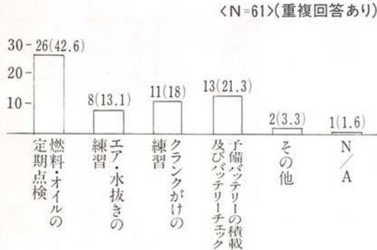
■基本的には定期点検など、日常の整備でトラブルを回避できるのでほとんどの艇が対策をたてている。落水、マストトラブルなどの対処の際も補機にたよることが多いので、点検の時期や項目などを規格化しておけば、より安全といえる。
