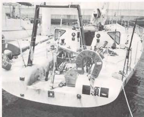
〈ドクターライ〉 トランサム上、黒のサポートはレーダー及び無線アンテナサポーター
