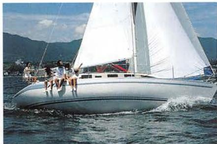
●全長9.31m ●水線長7.65m ●全幅3.25m ●吃水1.85m ●完成重量3.615kg ●ハラスト重量1.229kg ●全セル面積42.11㎡ ●ハース数7 ●呼称最大馬力18ps ●定員12名(平水) ●航行区域 遠洋 ※写真はオプションを含みます
