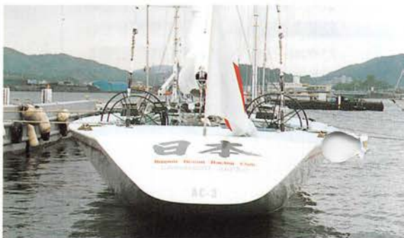
巨大なスピーンと細長い船体の対比が特徴的な“NIPPON”。マストはカーボン製で、ジャンパーステーなどにも様々な工夫がこらされているようだ
