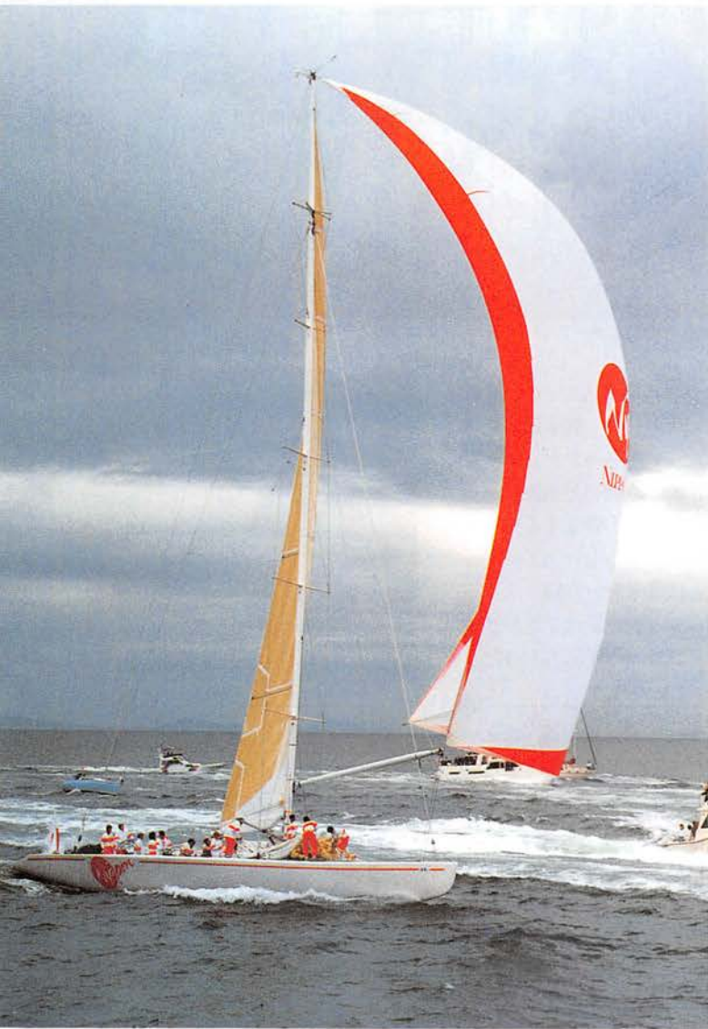
巨大なスピーンと細長い船体の対比が特徴的な“NIPPON”。マストはカーボン製で、ジャンパーステーなどにも様々な工夫がこらされているようだ
