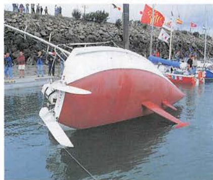
レースに先立ち90°傾斜試験が実際に実施される。インナーバラストがどのような状態でも、海面から12m程あるマストトップに45kgの重りをぶら下げてなお正の復原力を持つことが要求される。
