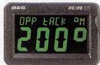
マスト付け根などに装備する20/20液晶大型ディスプレイ
