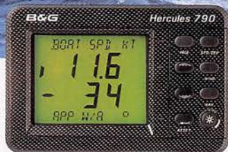
一台で複数のデータを表示する、液晶フルファンクション・ディスプレイ
