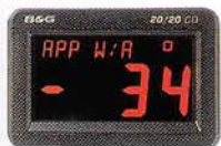
一台で複数のデータを表示する、液晶フルファンクション・ディスプレイ
